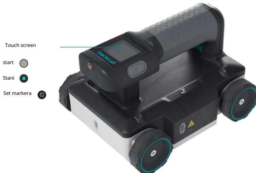
Slika 9: Funkcije ekrana osjetljivog na dodir GP8000 i GP8100
